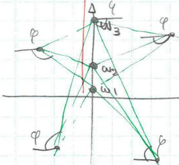
Punto  $w$  sull'asse reale di  $\text{Im}$ , vedo la lunghezza di tutti i vettori da ogni polo e zero e sommo le fasi per zeri, sottraggo fasi per poli, invece delle somma lunghezze vettori per avere il modulo totale del diagramma. Vediamo se c'è una singolarità posta sull'asse  $\text{Im}$ :
