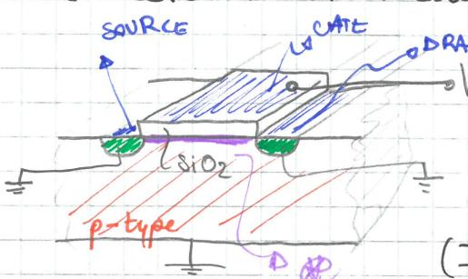
Metto Source,drain a massa e  $V_g$  sul gate
