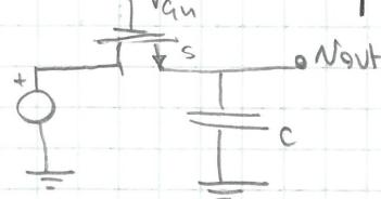
Così  $V_{GS,n} = V_{DD} > V_{TN}$
