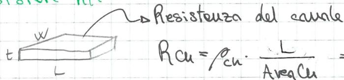
$$R_{ch} = \rho_{ch} \cdot \frac{L}{\text{Area}_{ch}} = \rho_{ch} \cdot \frac{L}{Wt} \quad \rho_{ch} = \frac{1}{q \cdot \mu_n \cdot n}$$
