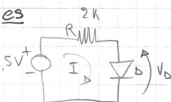
Per  $H_p$  suppongo polarizz. diretta. Sost con gen. tensione da  $0,7V \Rightarrow I = \frac{2,5-0,7}{2k} = 900\mu A$
