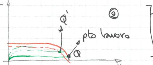
Le due caratteristiche rispettivamente si abbassano e si alzano fino a che il pMOS non entra in saturazione:
