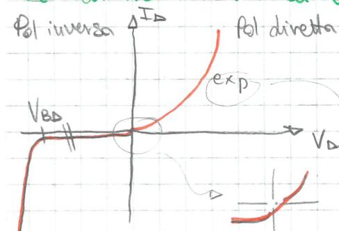
In pol inverso la corrente è trascurabile ( $\sim nA$ ) e non dipende dalla tensione
