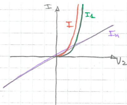
Ho un resistore integrato, quando  $V_2 > 0$  abbiamo un po' diretta fornita dalla giunzione pu.  $I = I_d + I_n$
