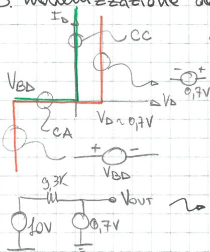
caratteristica vera: se le tensioni nel circuito sono  $\gg 0,7\text{V}$
