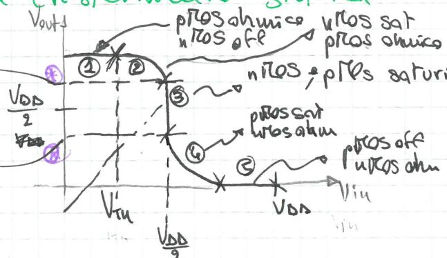
Nel momento in cui  $V_{iu} > V_{Tu}$ , nMOS si accende:
